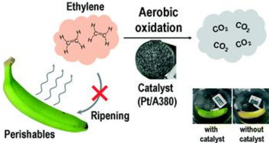
图2. 用于易腐物品保存的SiO 2 负载铂催化剂对易腐果蔬的乙烯氧化 [69]
