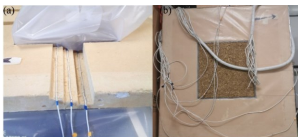
图 2. (a) 孔网和 (b) 试验墙。
