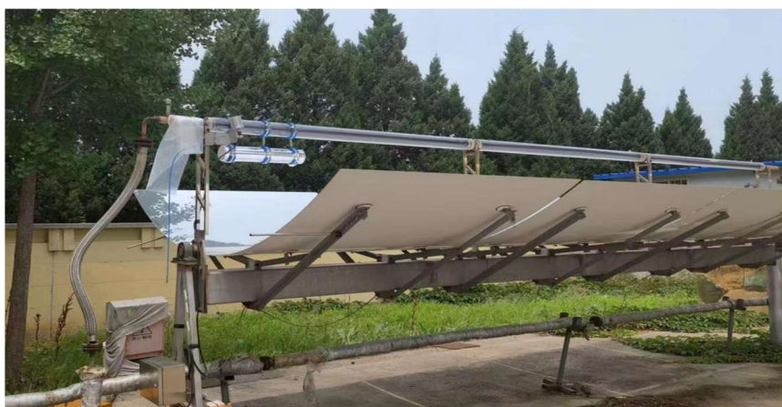
图 2. 新型槽式太阳能捕集与光运输装置。
