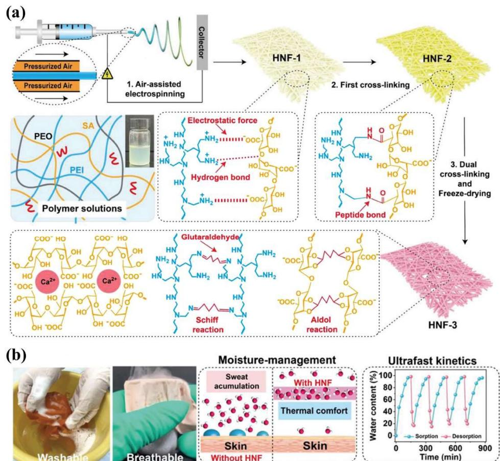
**图 1.** (a) 全聚合物吸湿织物的空气辅助静电纺丝示意图。(b) 研究中开发的具有透气性、耐用性、拉伸性和可洗性的全聚合物吸湿织物的示意图和数码照片，可实现快速可靠的蒸发冷却和热管理 [15]。版权所有 2023, Wiley-VCH。
