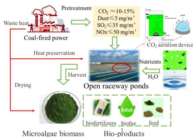
图 1. 燃煤电厂烟气用于开放式跑道池微藻培养的原位开放路线。
